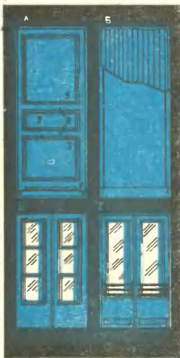
Дверные полотна: А — филенчатое дверное полотно, 1 — обвязка дверного полотна, 2 — средники, 3 — филенка; Б — щитовое дверное полотно, облицованное фанерой; В и Г — дверные полотна с остеклением.
